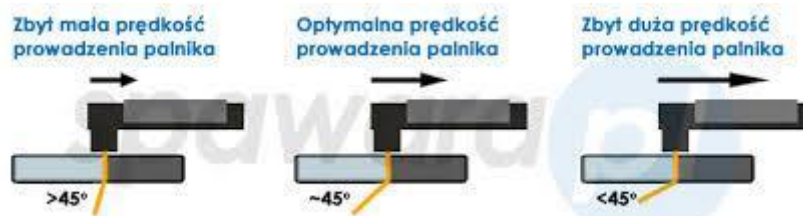
Zależność kąta wypływu żużla od prędkości cięcia
